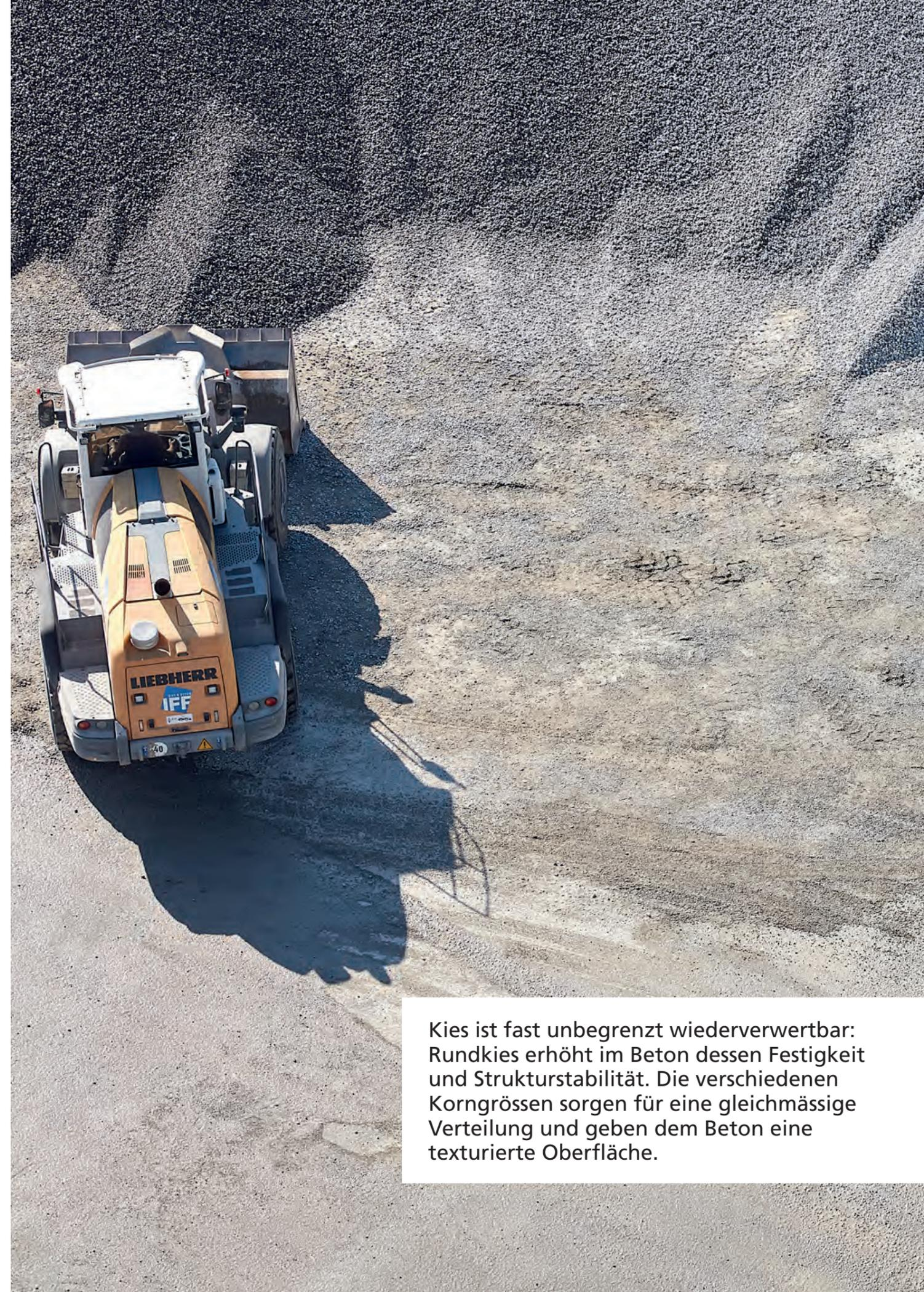
Kies ist fast unbegrenzt wiederverwertbar: Rundkies erhöht im Beton dessen Festigkeit und Strukturstabilität. Die verschiedenen Korngrößen sorgen für eine gleichmässige Verteilung und geben dem Beton eine texturierte Oberfläche.
