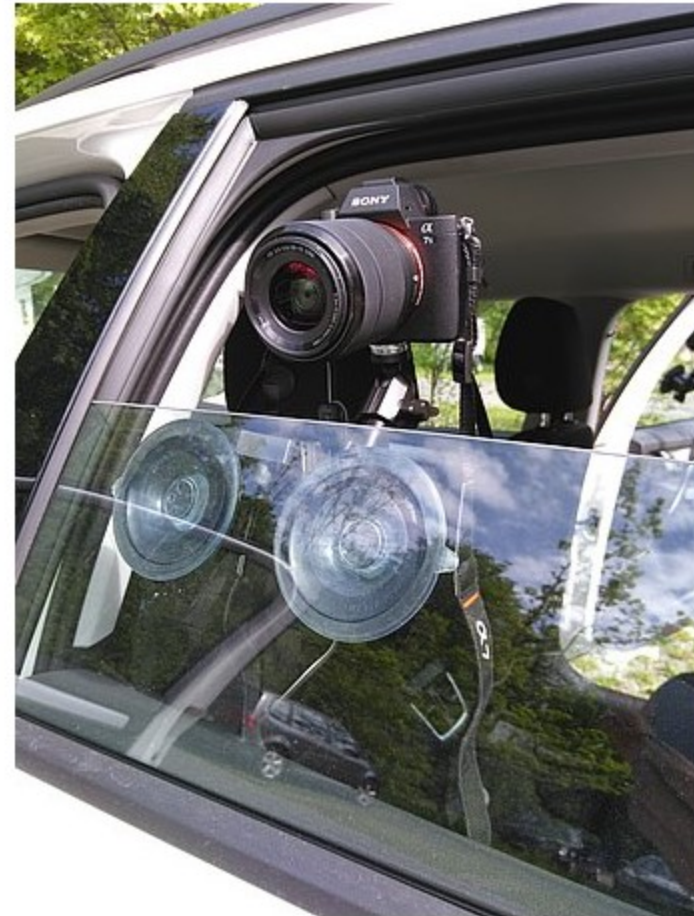
Die fahrbahnahe Vegetation der Mittel- und Seitenstreifen wurde mit zwei Kameras senkrecht zur Fahrrichtung gefilmt.
